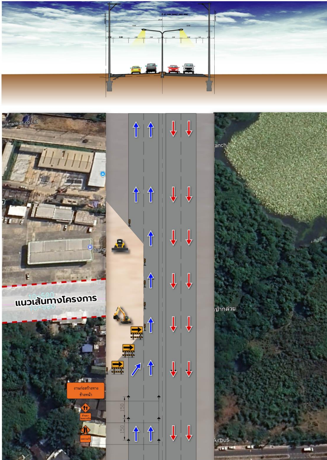
รูปที่ 6.7-3 การจัดการจราจรระหว่างก่อสร้างบนถนนพระยาภิเษก
